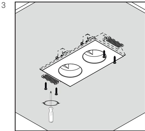
Установите корпус (поз. 1) в отверстие и закрепите его с внешней стороны потолка саморезами, идущими в комплекте (поз. 4).
