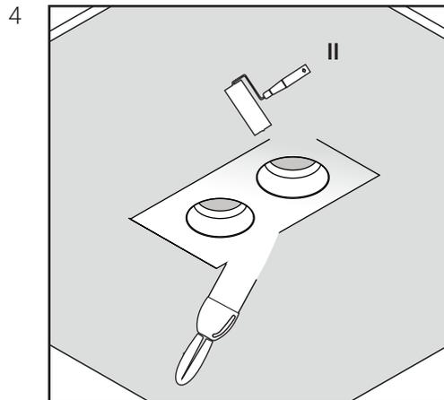
После установки следует зашпаклевать швы, покрасить потолок и гипсовый корпус светильника.
