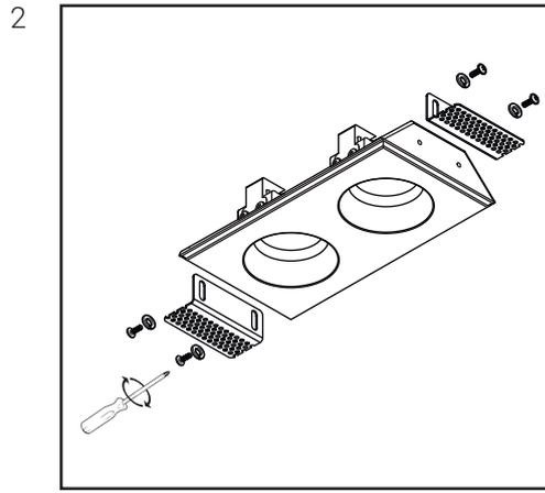
Отрегулируйте крепежный элемент (поз. 3) в зависимости от толщины потолка. Закрепите его с помощью винтов (поз. 5) и шайб (поз. 6), идущих в комплекте.
