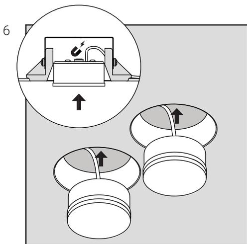
Установите световые модули в корпус используя магнитное крепление.
