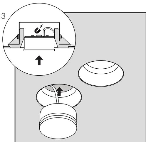
Установите световые модули в корпус используя магнитное крепление.
