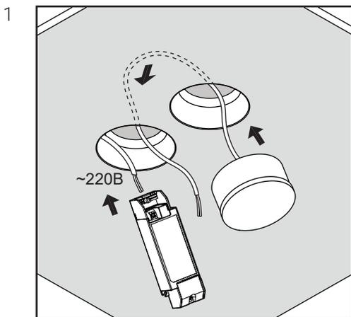
Подключите блок питания к электросети выбрав соответствующую схему, смотрите стр. 5. Проденьте провод светового модуля через гипсокартонный корпус в соседнее отверстие к блоку питания.
