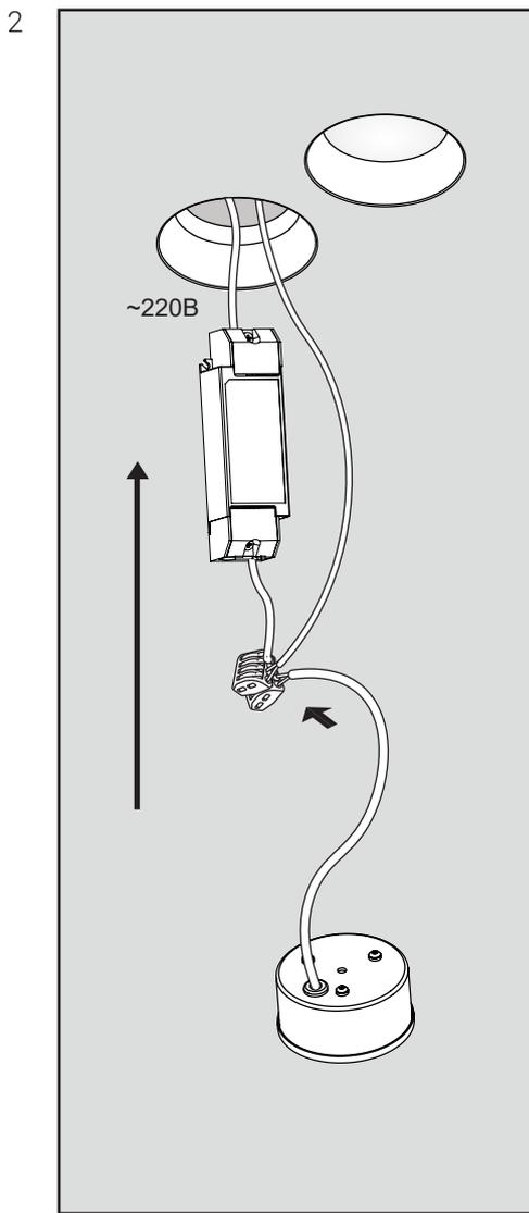
Подключите световые модули к блоку питания с помощью клем с соблюдением полярности, а затем разместите его за гипсокартонным потолком.
