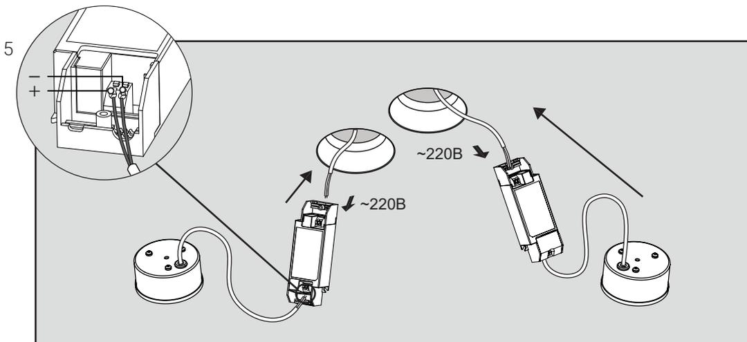
Подключите световой модуль (поз. 2) к блоку питания (поз. 3) с соблюдением полярности. Затем подключите блок питания к электросети выбрав соответствующую схему смотрите стр. 5, а затем разместите его за гипсокартонным потолком.
